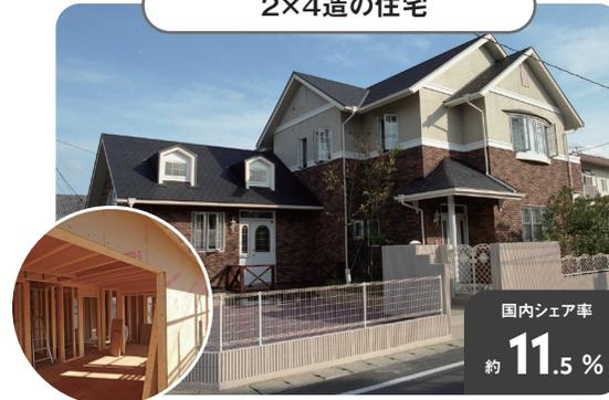
2×4造の住宅は、2×4インチの木材を組んだ枠組みに構造用合板を張り付けたパネルで組み上げる六面体構造を持つ。枠組み壁工法と呼ばれ、頑丈で、高气密化しやすいなどのメリットの反面、施工中の雨に弱い、背の高い窓が取り付けにくい、コーナーに窓を設置できないなどのデメリットがあると言われている。アメリカが開発され1950年代以降北米で急速に普及し、1970年代に三井ホームが導入し、日本でも普及が始まった。
